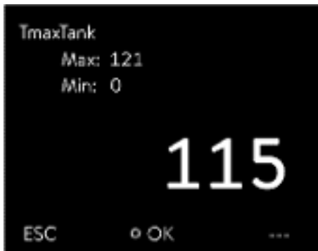
Fig. 43 : Saisir la nouvelle Tmax/Réservoir
